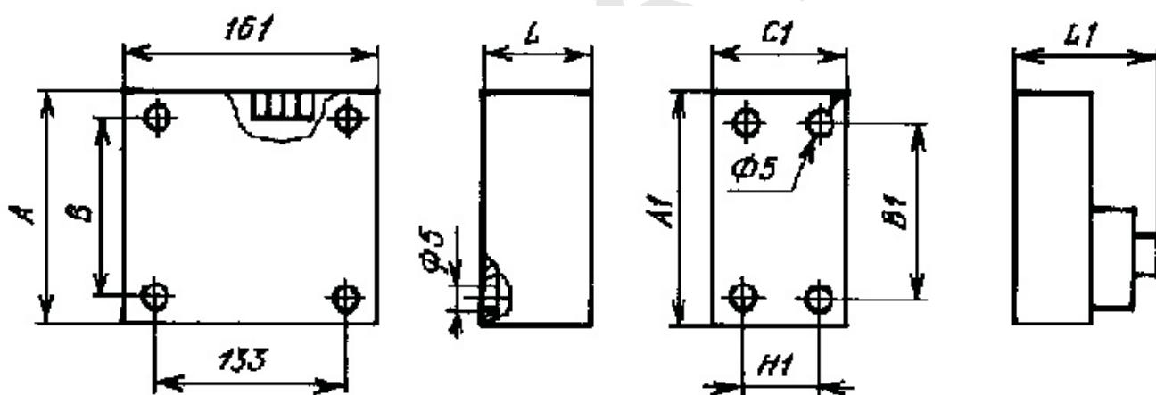
Габаритные размеры сглаживающих реакторов - на рис. 4.:
