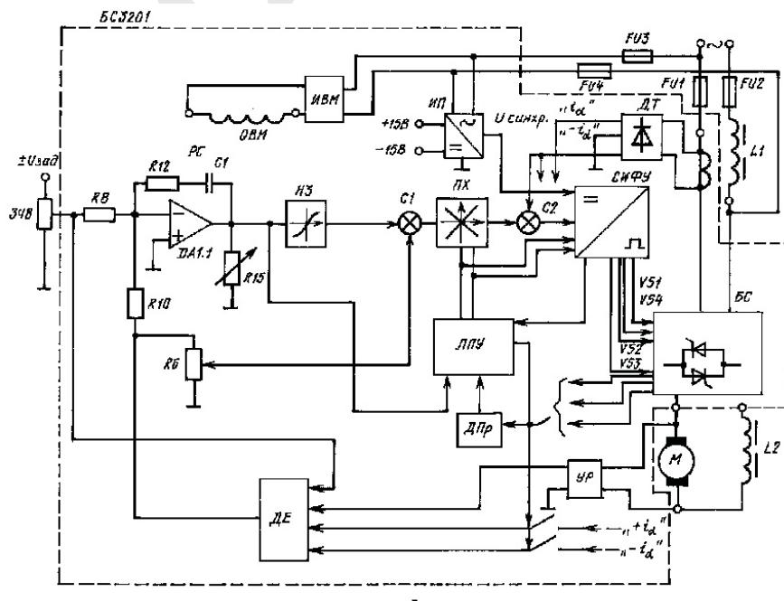
Коммутационный реактор выполняет следующие функции: снижает нелинейные искажения, вносимые электроприводом в питающую сеть; исключает взаимное влияние электроприводов при их одновременной работе от общей сети.
