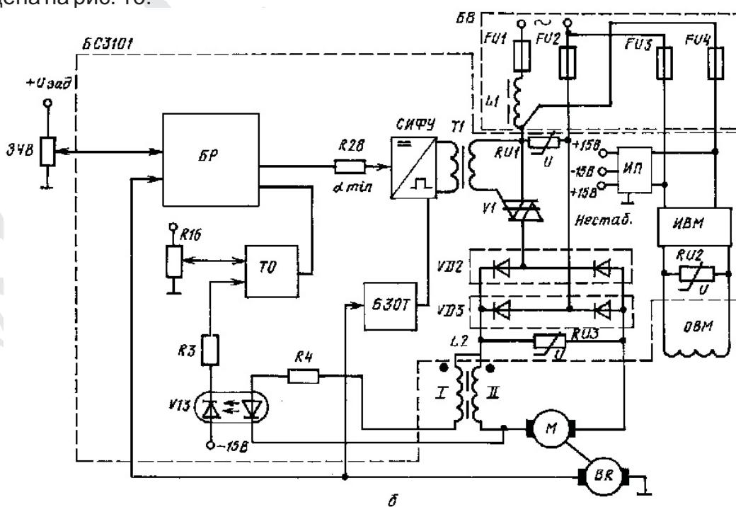
Электропривод ЭПУ2-1 состоит из блока ввода (БВ) и блока управления БС3101, задатчика частоты вращения (ЗЧВ), сглаживающего реактора L2 и двигателя M.
