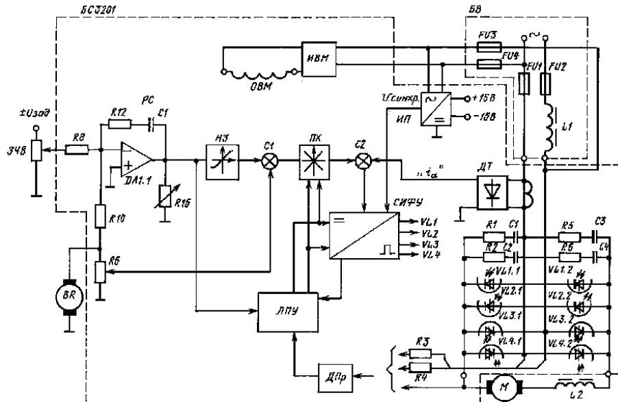
Функциональная схема однофазного реверсивного электропривода ЭПУ2-2 исполнения Е приведена на рис. 2б:
